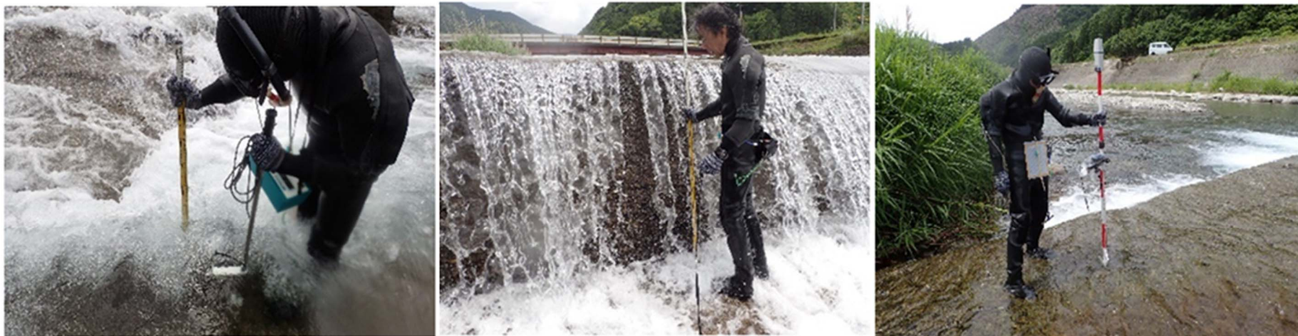
水深・流速(左)、水面落差(中)、周辺地形(右)の各計測状況
