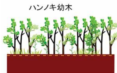
➤ 湿潤な高さまで掘削を行い、ハンノキの幼木を移植
