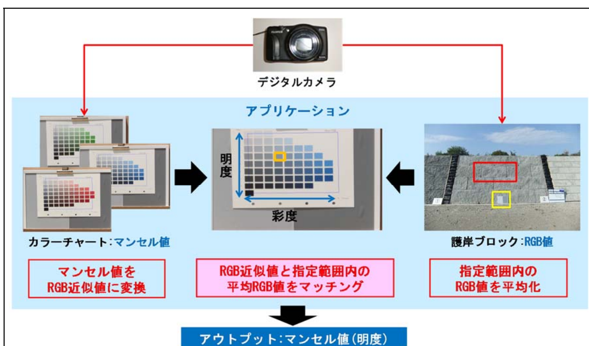
図-33 護岸ブロックの明度評価手法の概要
