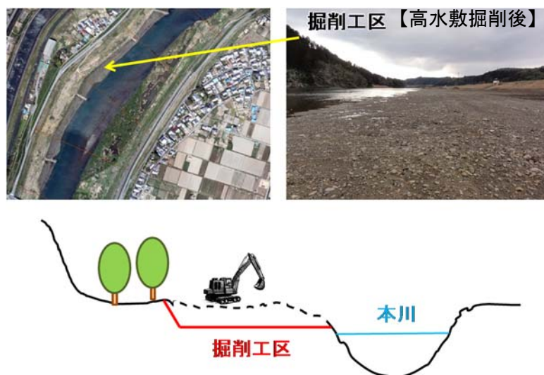
図-1 河道掘削（高水敷掘削）のイメージ
