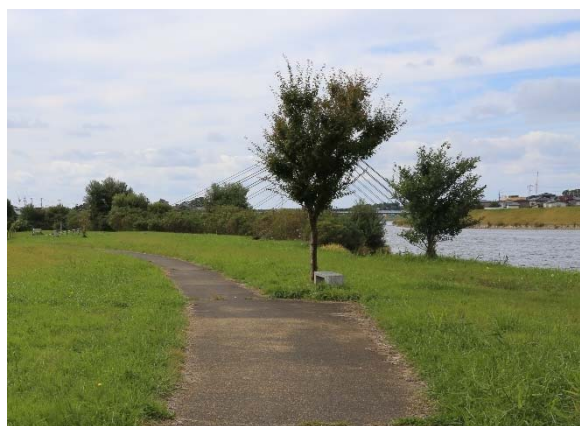
写真-11 車椅子を停めて休めるスペース(園路が広がっている箇所)とベンチ
