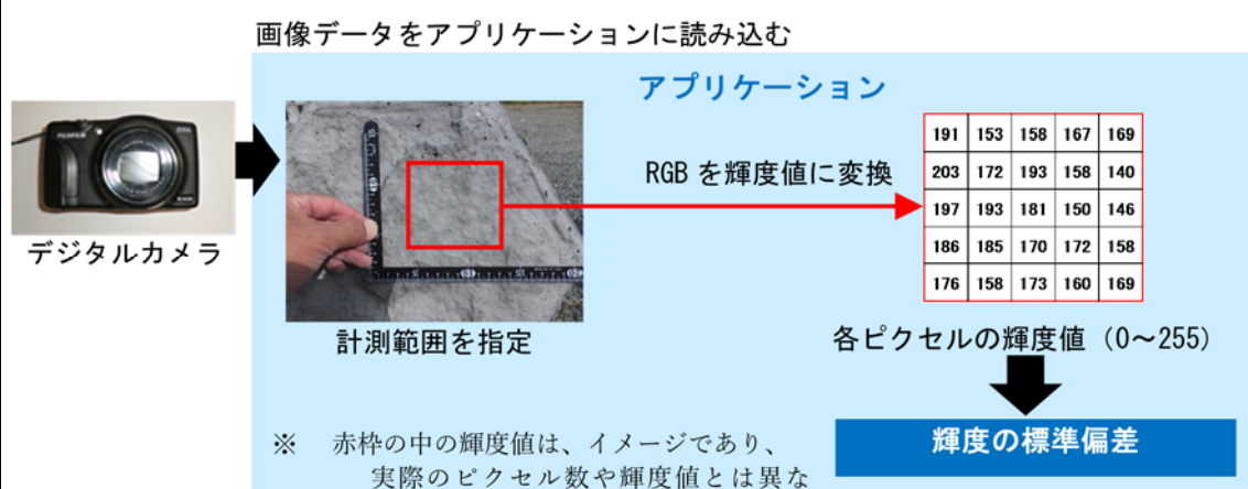
図-34 護岸ブロックのテクスチャー評価手法の概要
