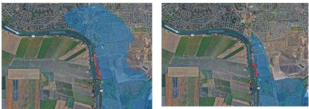
図 3.3.7 越流幅を変えた氾濫シミュレーション結果の比較例<sup>2)</sup>
