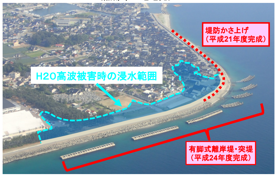
冬季風浪による高波被害(平成20年2月)の浸水範囲と対策状況 (黒部市生地地先)
