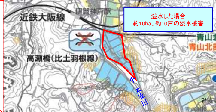
比土水位観測所地点で溢水(右岸)した場合の浸水想定(推定) ※伊賀市洪水ハザードマップより算出
