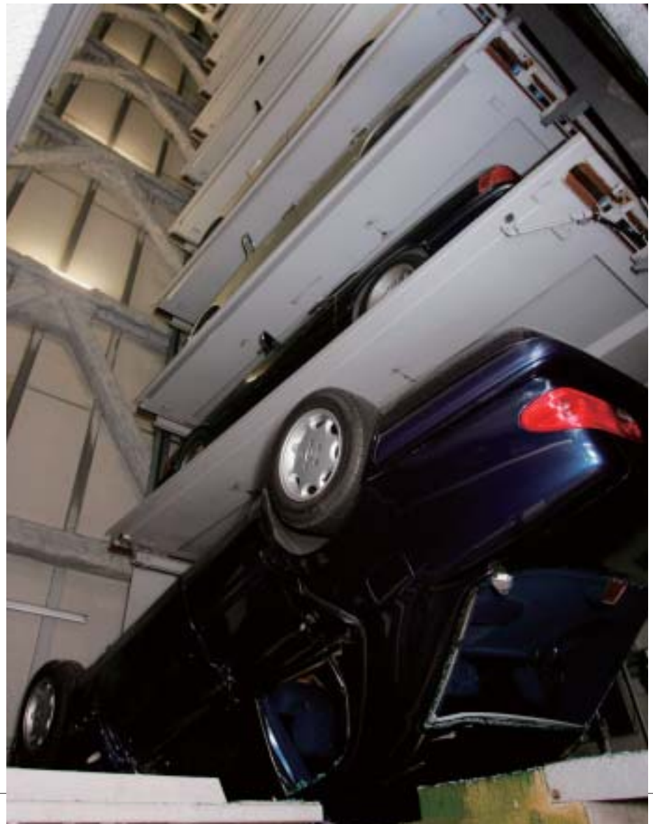
▼地震の揺れでタワー型立体駐車場から約10メートル落下した乗用車（東京都江東区）〔写真提供/毎日新聞社〕
