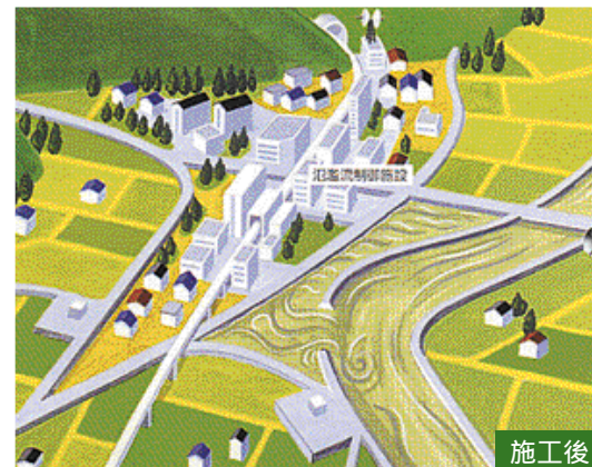
横堤の築堤、道路の嵩上げにより、市街地への氾濫を防御
