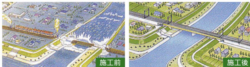
鳥居川 長野県 洪水の疎通能力の低い鉄道橋の架替えを実施。
