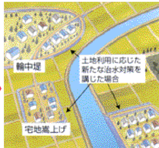
輪中堤や宅地嵩上げを効率的に短期間で実施することにより、家屋の浸水被害を解消。
