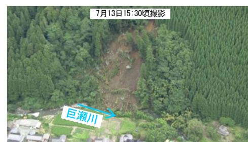
7月13日 15:30頃撮影 ちくごがわ こせがわ 筑後川水系巨瀬川（福岡県うきは市） 崖崩れにより土砂が河川に流れ込み流下を一部阻害 （応急対策実施中）
