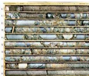
ボーリングコア調査
