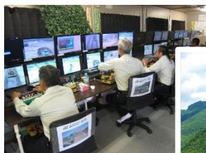
左図：無人化施工操作室
