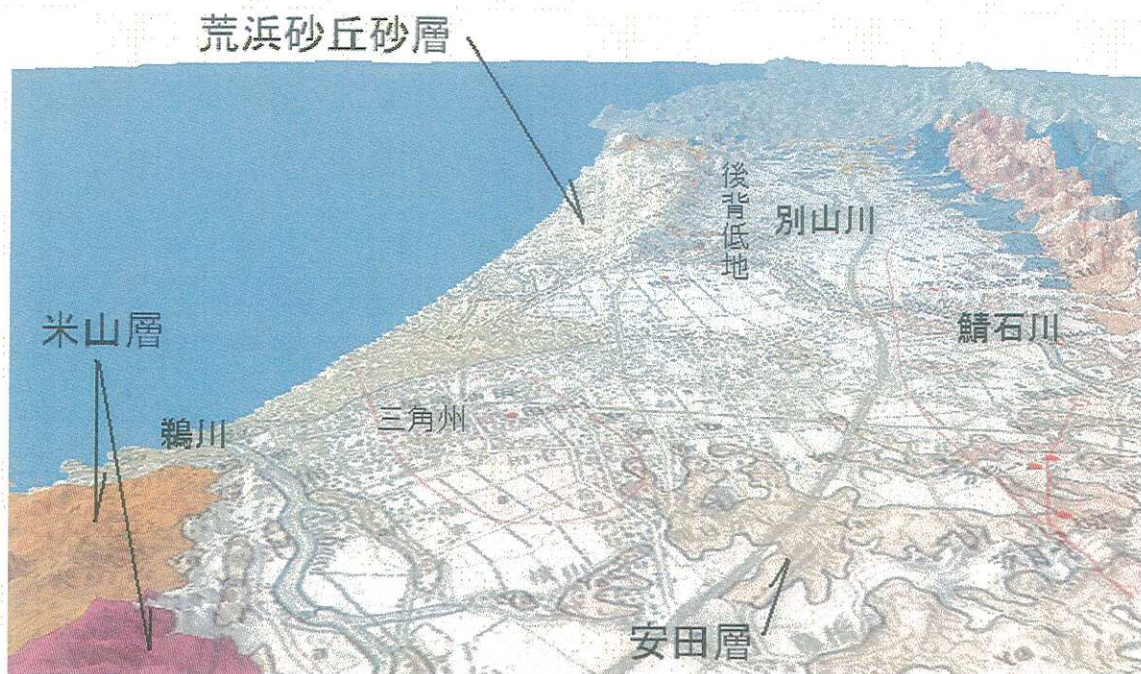
図 2 - 1 - 1 柏崎市周辺の地形・地質的特徴 (50mDEM に 5 万分 1 地質図を貼り付けたもの)
