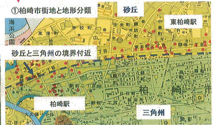
旧柏崎市街地 地理的要因(砂丘と三角州の境界付近・旧河川敷) に加え、古い木造建築物が被災
