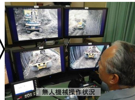
滑落崖に近接する箇所の排土整形無人化施工の実施(北股地区の例)
