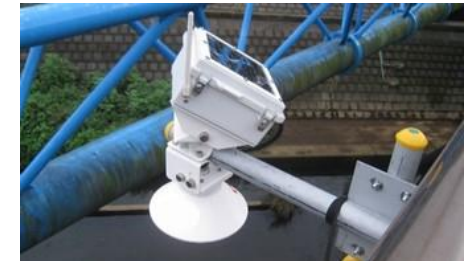
洪水に特化した低コストな水位計
