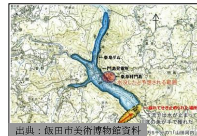
1718年 門島地区近傍での地すべり発生事例 ・遠山地震により地すべりが発生し、土塊が天竜川を閉塞。
