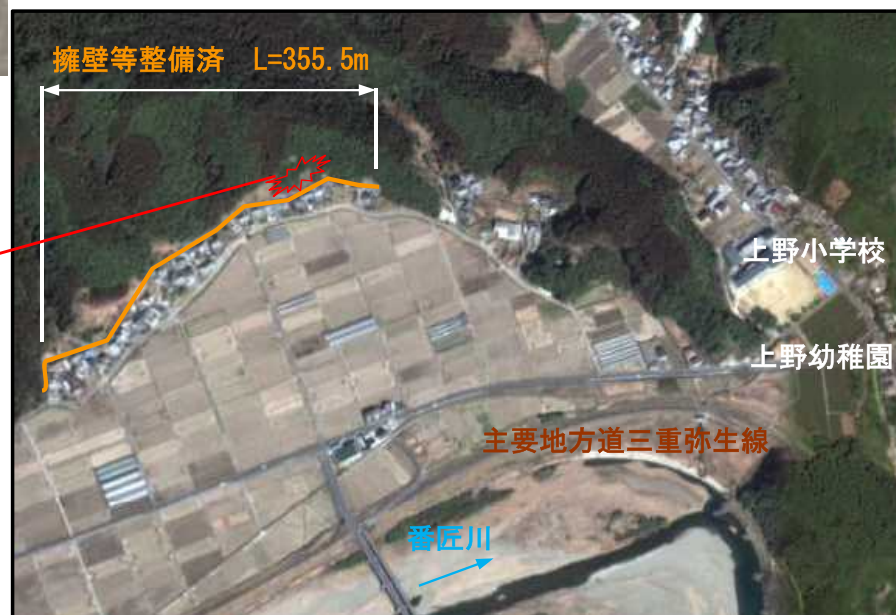
待受擁壁により崩壊土砂から家屋が守られた
