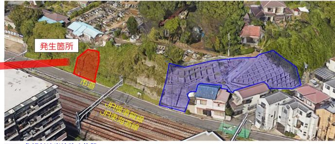
急傾斜地崩壊防止施設 (法枠工)
