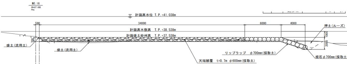
整備計画流量流下時の移動限界粒径よりΦ700mmの巨石を採用
