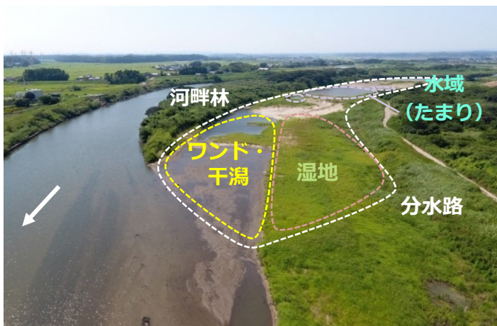
河道掘削後の多様な自然環境の創出(久慈川)
