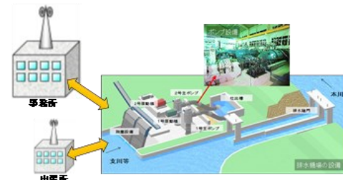
遠隔監視・操作により、緊急時においても排水作業が可能（排水機場の遠隔化イメージ）
