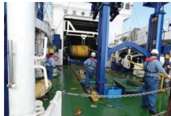
受振系仕様(ストリーマケーブル)・・・ ケーブル長は約6000 m、チャンネル数444、 受振点間隔12.5 m、曳航深度12 m
