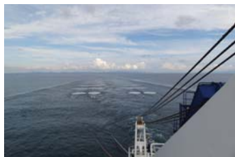
震源系仕様(エアガン)・・・ 空気圧2000 psi、総容量7800 cu.in、 発震点間隔50 m、曳航深度10 m
