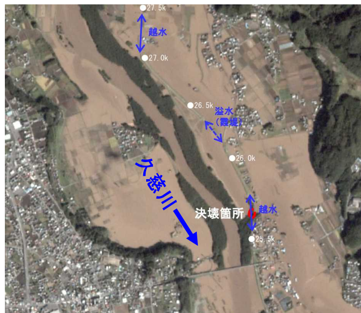
久慈川左岸25.5kの決壊箇所(2019/10/13撮影) (出典: 防災科学研究所クライシスレスポンスサイトに加筆)
