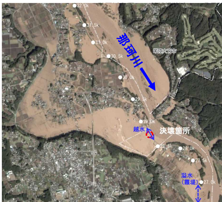
那珂川右岸28.6kの決壊箇所(2019/10/13撮影) (出典:防災科学研究所クライシスレスポンスサイトに加筆)
