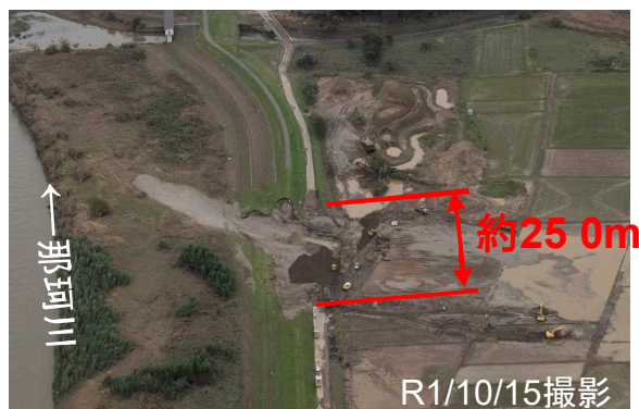
那珂川右岸28.6kの決壊箇所(2019/10/13撮影) (出典:防災科学研究所クライシスレスポンスサイトに加筆)
