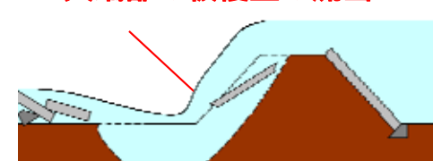
天端部の被覆工の流出
