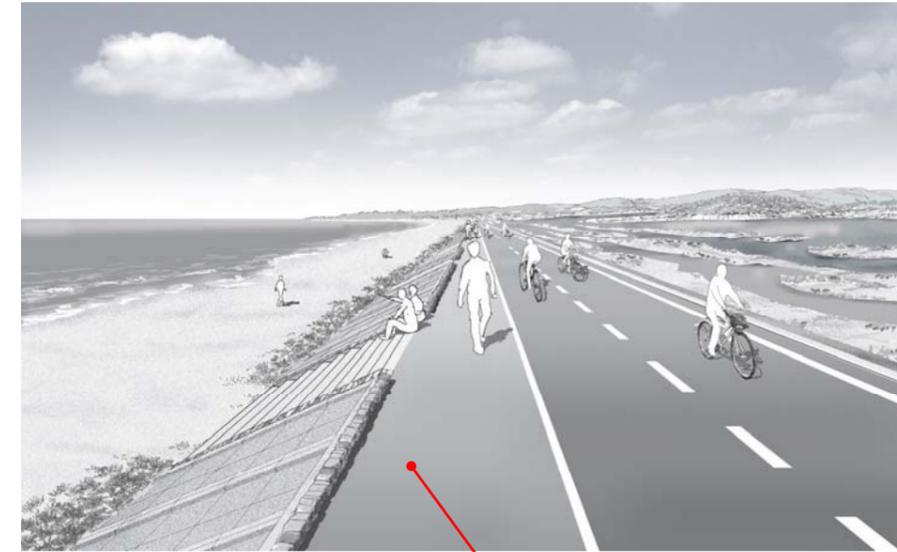
天端を舗装する場合は、脱色アスファルト等で自転車道と区分し分節化を図る
