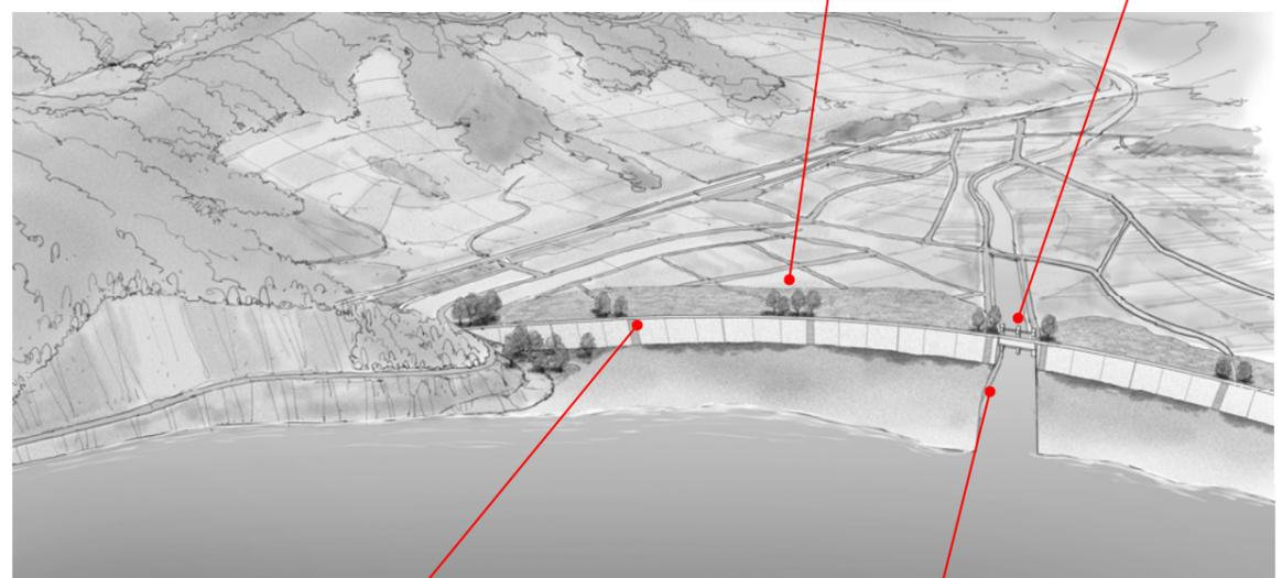
階段等の配置は、海岸堤防端部や水門等構造物の箇所、および背後地の土地利用や利用状況を踏まえて、概ね100～300mに1箇所設けることとするが、海岸堤防の延長を考えバランスの良い位置に設置する（一連の海岸堤防の中心には設置しない）
