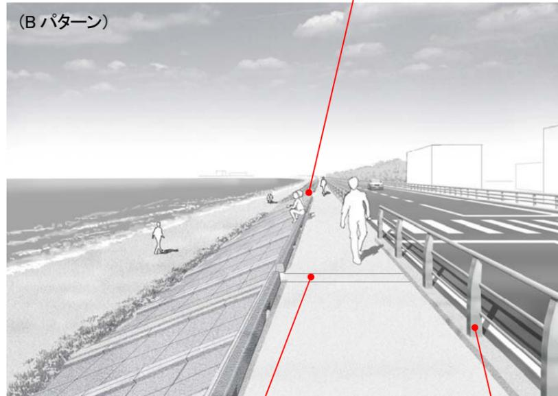
縁石や天端コンクリート(法肩部)は、目立つため、洗い出し加工された製品や洗い出し処理を行い、明るさを落とし、柔らかい印象を与える
