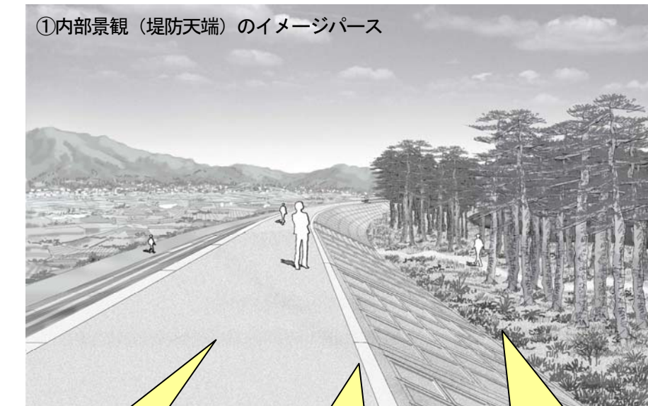
①内部景観（堤防天端）のイメージパス 天端の視点場としての活用への配慮 利用に配慮した付帯施設の整備 堤防表裏法尻への覆土等による周辺環境との一体化
