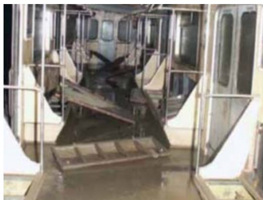
プラハの洪水により水没した地下鉄車両
