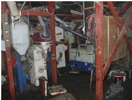
被災したもみすり機 (修理はほぼ不可能であるが農工機械一式買い直すと1千万円程度掛かるので農業から廃業した農家も多い)
