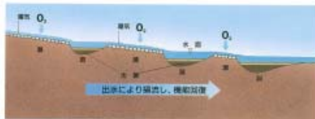
瀬と淵を利用した浄化施設（大和川での例）
