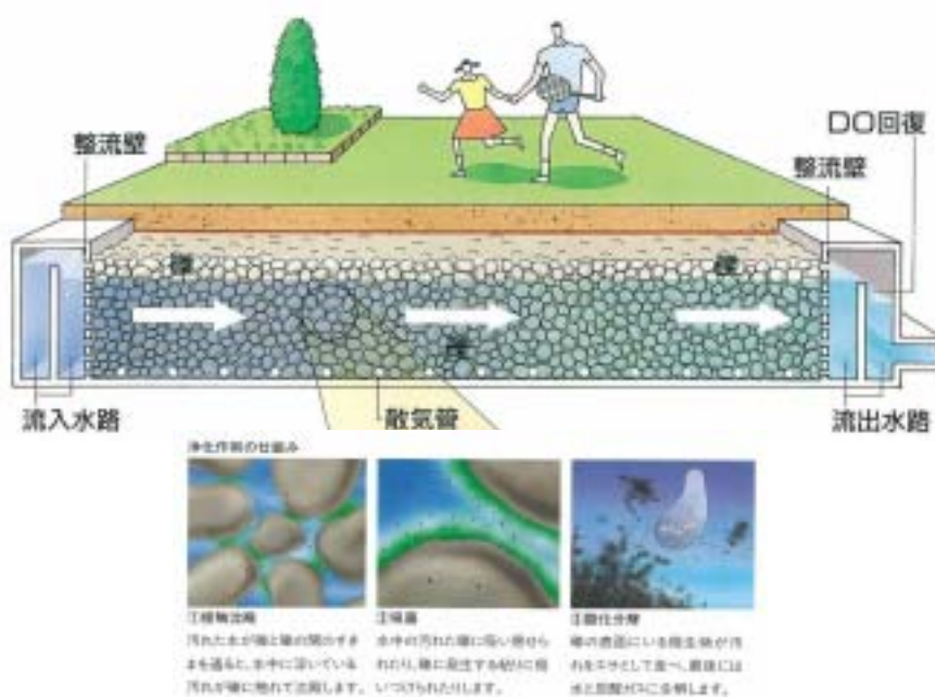
図 2.7 礫間接触酸化法
