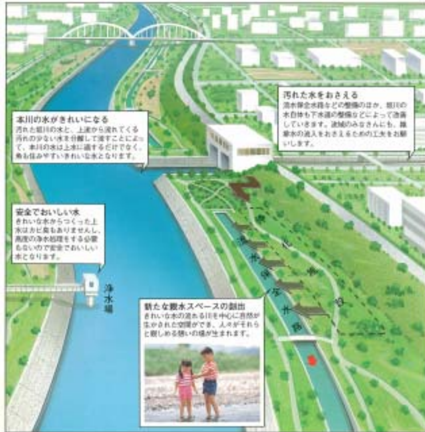
図 2.12 流水保全水路
