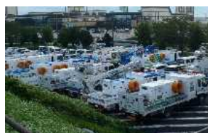
排水ポンプ車
