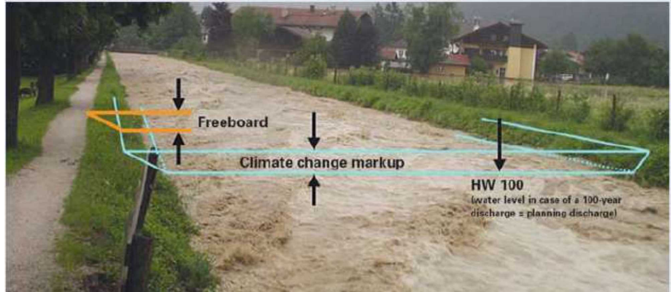
図 100年確率洪水位及び気候変動による水位上昇見込み量概念図 ※「Freeboard」は波・風等による水位上昇による越流を防止するためのもの
