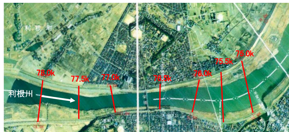
布川狭窄部によるせき上げを抑えるため、布川狭窄部上流の掘削で容量を確保
