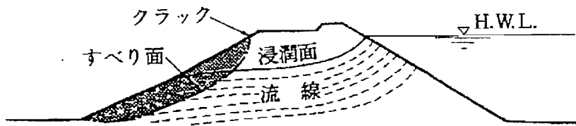
図2 堤防の浸透破壊の機構
