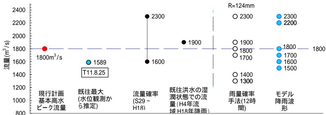
図 4-7 各手法による基本高水のピーク流量算定結果
