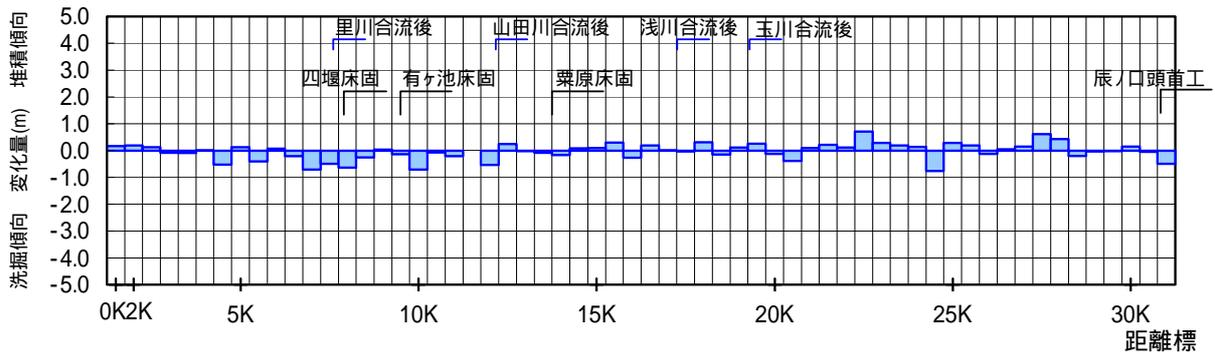
図 2-4 低水路内河床変動量の経年変化図
