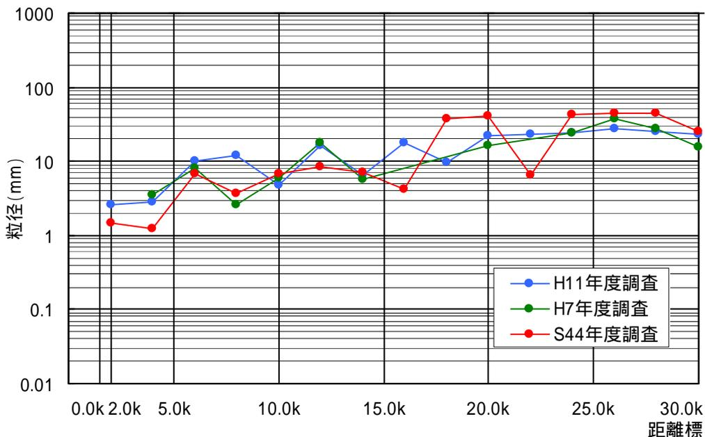
図 2-6 代表粒径の縦断分布の経年変化
