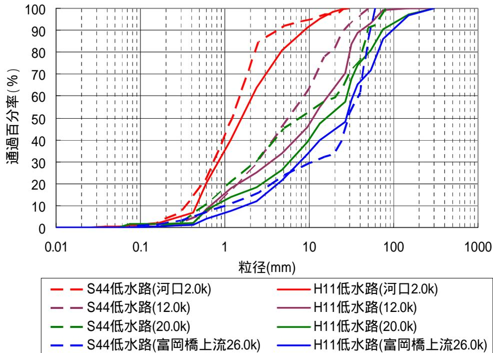
図 2-5 河床材料の経年変化 ( S44 H11 )
