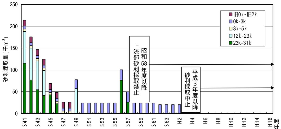
図 2-1 砂利採取量の経年変化図
