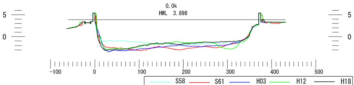
図 3-2 河口部の経年変化横断面図
