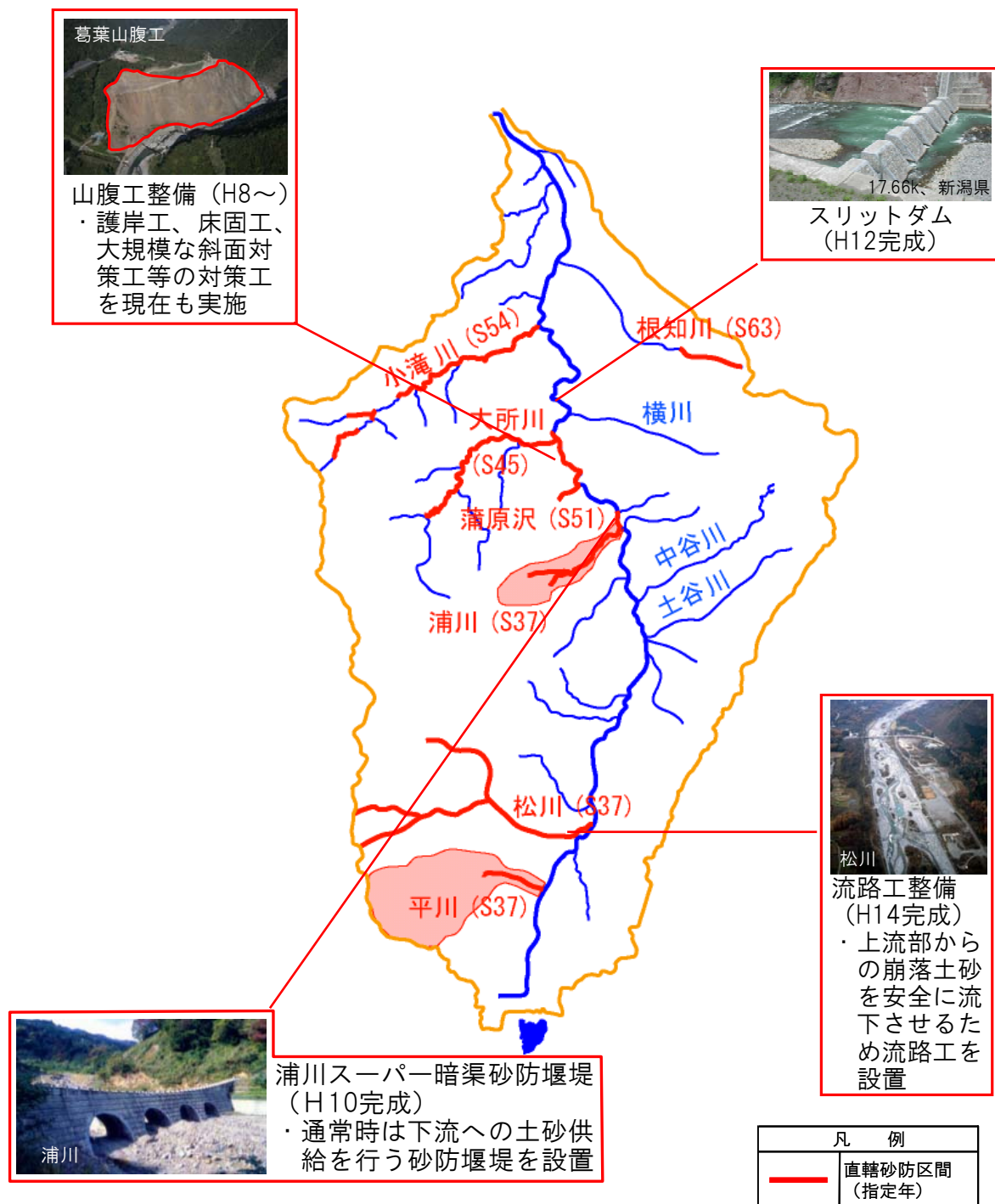
図 4-5 上流部での土砂対策
