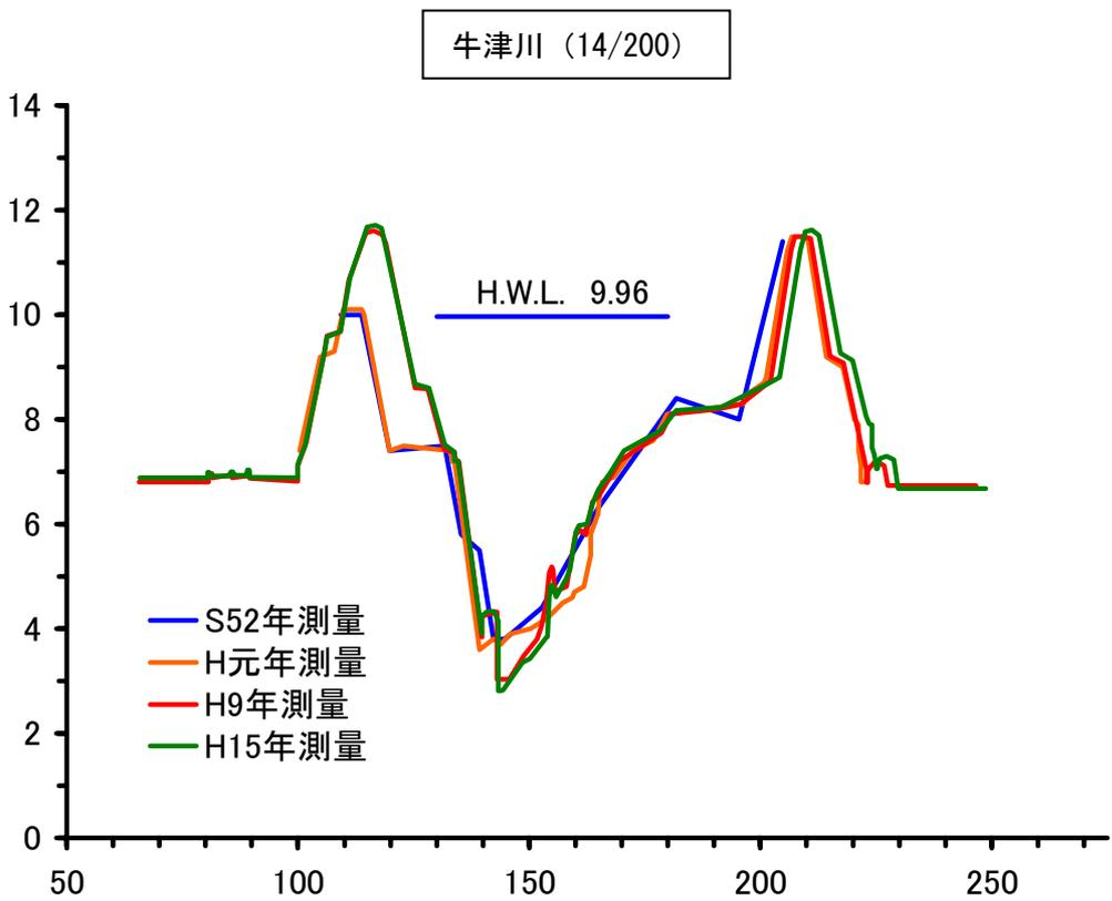
図 2-4 (2) 代表断面における横断形状の経年変化
