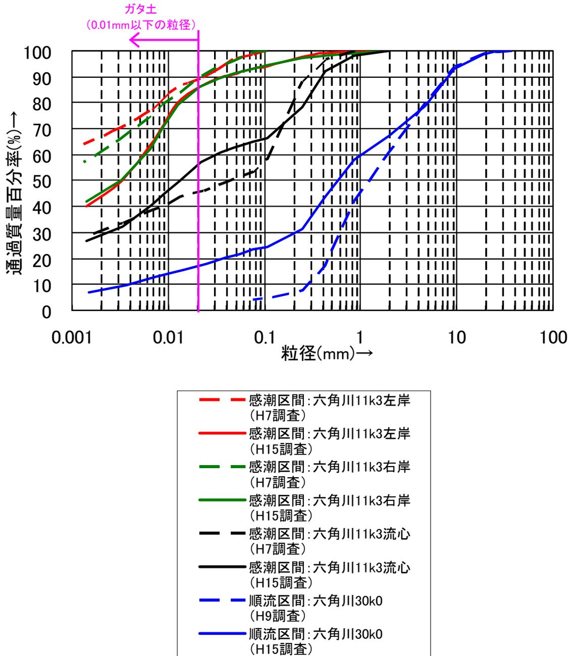
図 2-3 河床材料の経年変化
