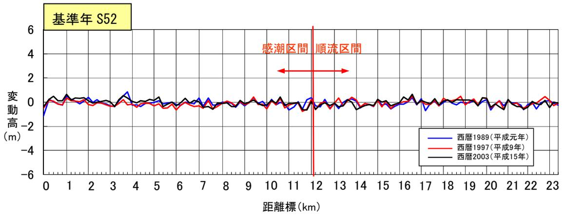
图 2-2 (1) 六角川低水路平均河床高縦断面図
