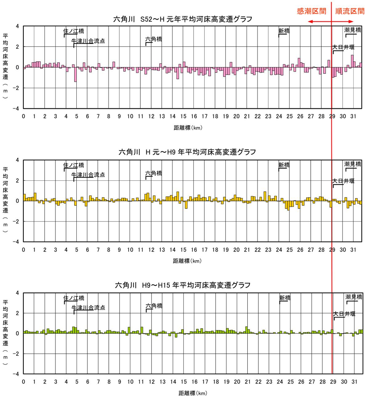
図 2-1 (2) 六角川の河床変動傾向 (低水路平均河床高)
