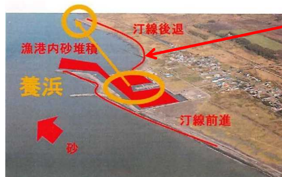
写真 2-15 鷓川漁港内浚渫土砂を汀線回復のために河口付近に置土した北海道の事業
