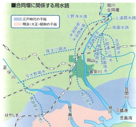
図-5.3.2 旭川合同堰に関する用水路
