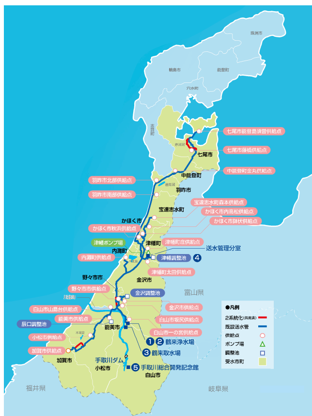
図5-5 手取川ダムからの上水道供給範囲
