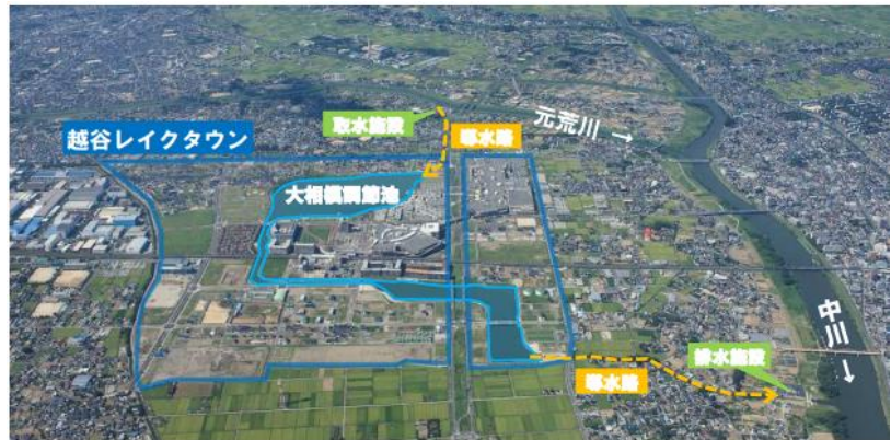
大相模調節池(容量:120万 \text{m}^3 ／治水+開発増分)
