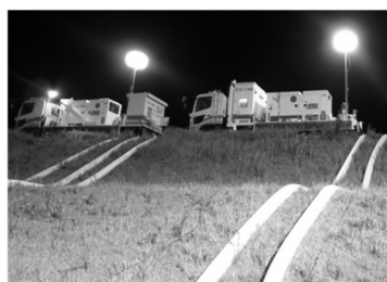
浸水エリアに排水ポンプ車を派遣し緊急排水を実施 (H25.9 台風 18 号 京都府福知山市)
