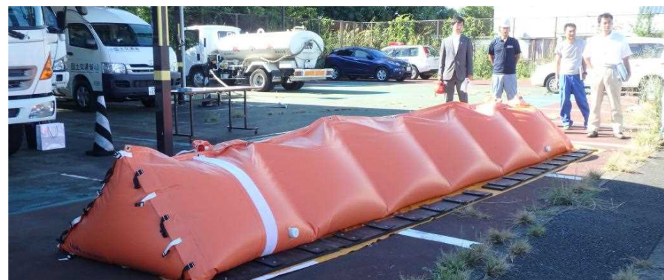
水防資機材(水のう)の点検 (安倍川)
