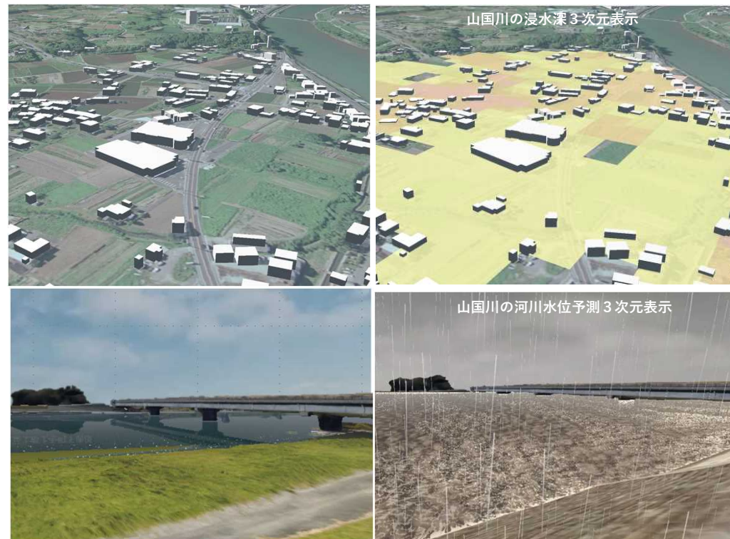
3次元データ・解析技術を活用した水害リスクの見える化（イメージ図）
