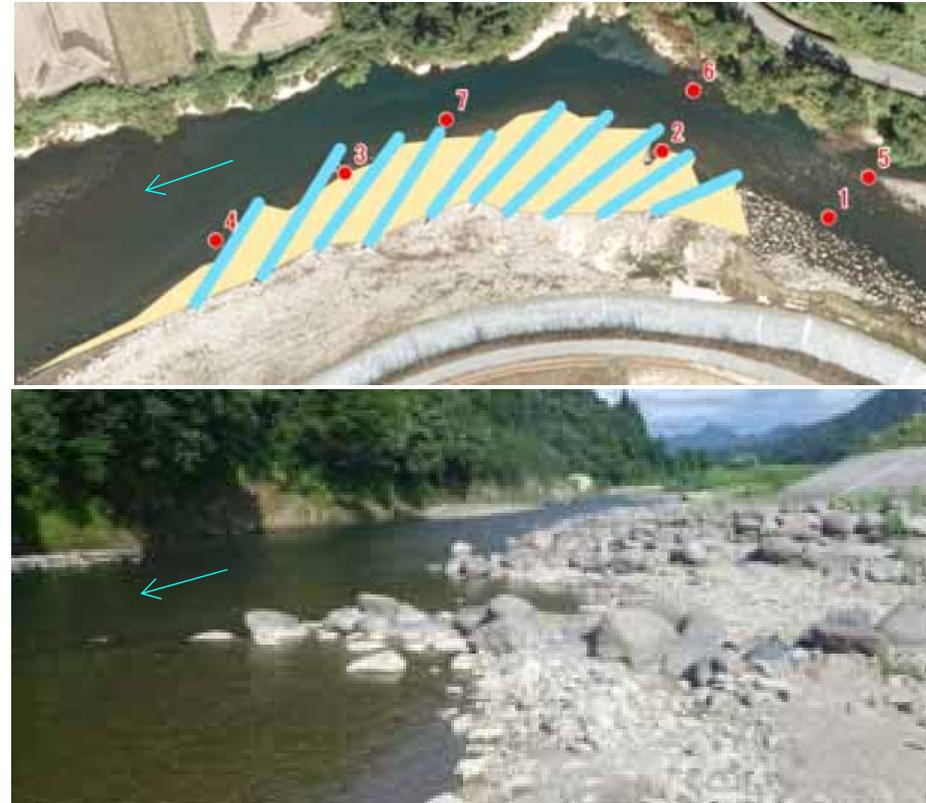
バーブ工は、河岸との角度が $20\sim 30^\circ$ という鋭角上向きの水制状の構造物で、流向を対岸方向に変える、バーブ工先端下流に淵を形成する、バーブ工周辺に土砂を堆積させるなどの働きがある。
