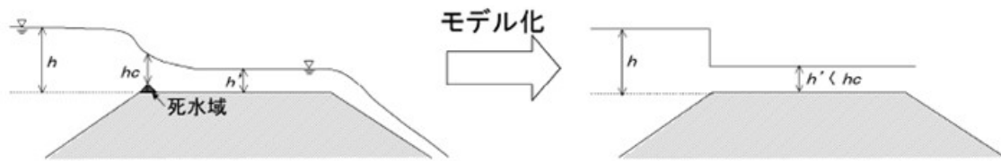
図 5.4-7 堤防天端の越水のモデル化
