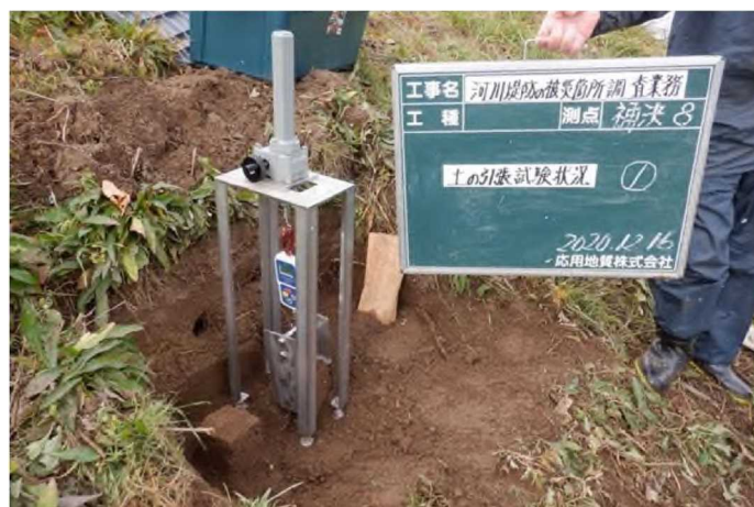
写真 2.3-5 引張破壊応力試験の様子
