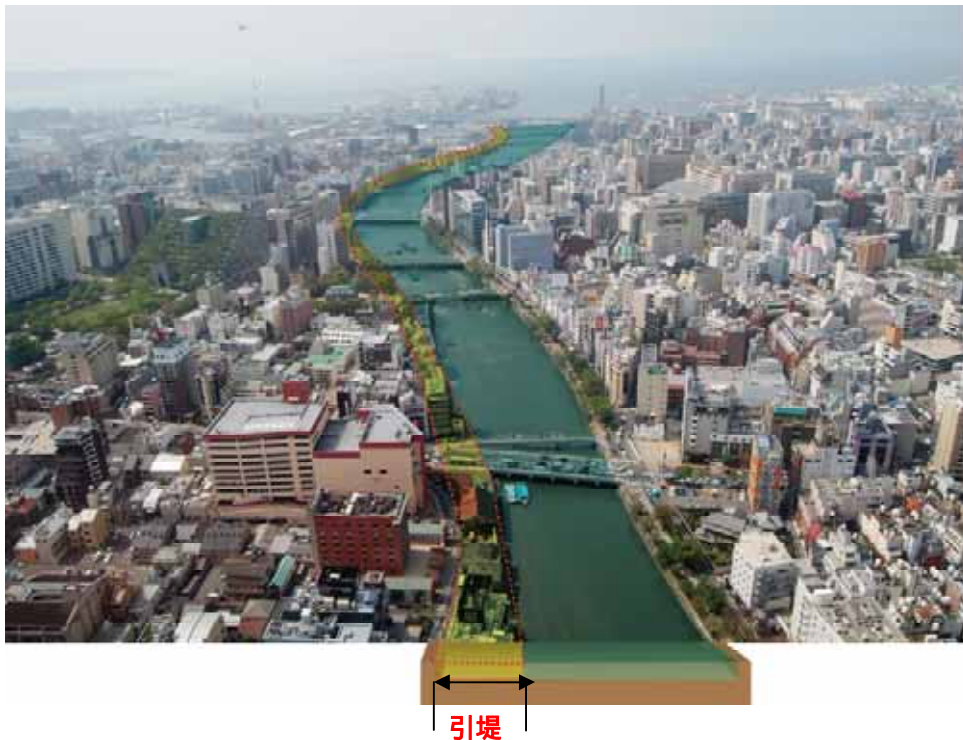
図 4.40 那珂川引堤イメージ図
