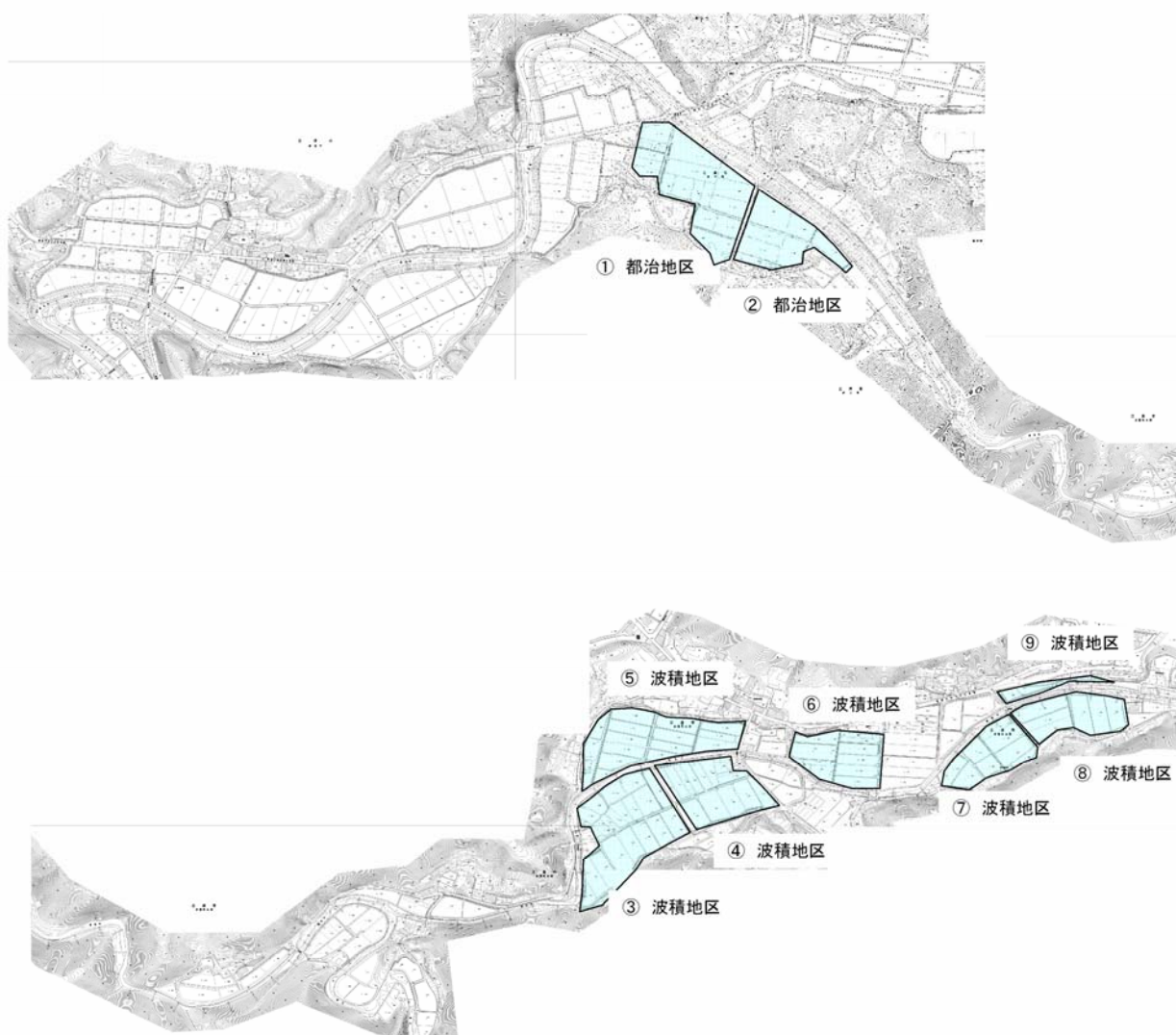
図 4.7.3 河道外貯留施設建設位置
