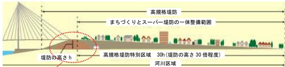
図 4.2.4 高規格堤防（スーパー堤防）の概念図
