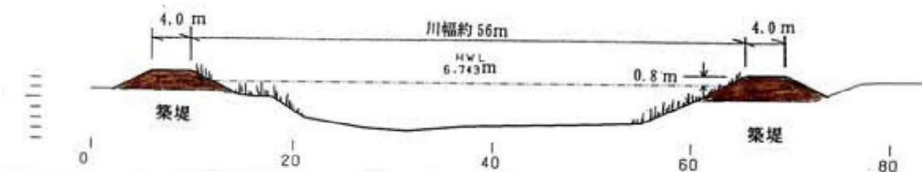
標準断面図(A-A断面)
