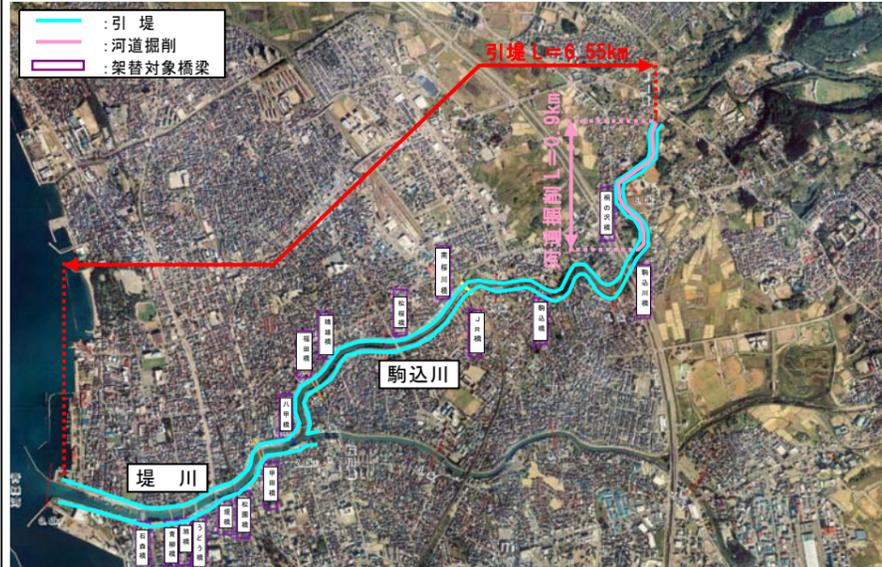
○堤川・引堤＋河道掘削(概算数量・金額)
